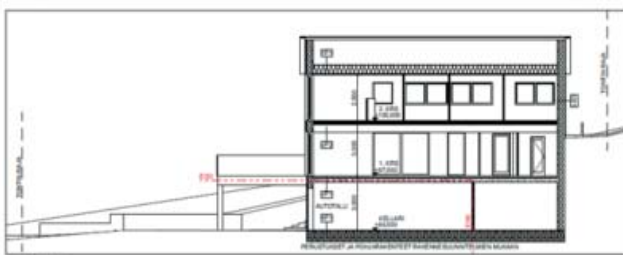
Poikkeamisluvalla haetun rakennuksen leikkauspiirustukset, joissa näkyy huomattava korkeus yli 11 metriä ja pituus noin 20 metriä. Tontin korkeussuhteet vaihtelevat +94,0 ja +100,0 välillä eli tasoero on yli 6 metriä.
